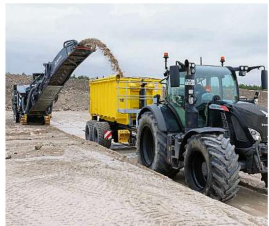
Verfüllmasse wird „geerntet“. Das Salz ist in festem Zustand auf Halde gelagert und wird mit Spezialgerät losgefräst. Foto: dpa
