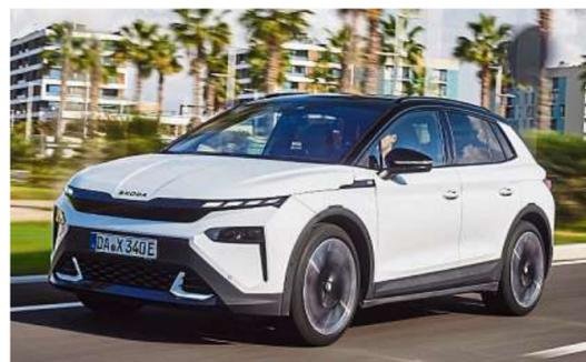
Der Škoda Elroq ist 4,49 Meter lang, 1,88 Meter breit und 1,65 Meter hoch. Foto: Škoda
